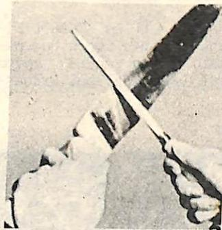
Las tijeras se afilan mejor en la piedra. Se mantiene plana sobre el filo en bisel y se desliza sobre la piedra con movimientos repetidos varias veces (foto 6).
